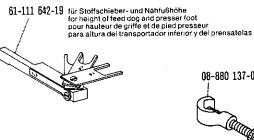
08-880 137-00 für Greiferbewegung for looper motion pour mouvement du boucleur para el movimiento del garfio
